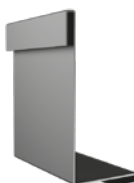
10 Vnitřní zapravení parapetu
