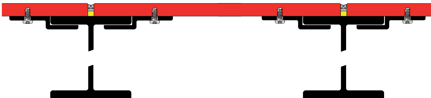
BALKONOVÁ PODLAHOVÁ DESKA UPEVNĚNÁ NA OCELOVÉM NOSNÍKU (NEPŘIZVANÉ UPEVNĚNÍ – ŠROUBEM)
